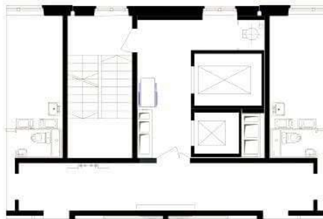
Рисунок А.1 - Вариант устройства безопасной зоны в жилом здании - при лестнично-лифтовом узле
